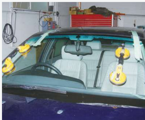
フロントガラス交換作業
